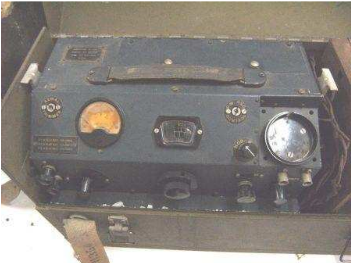
Dan huwa r-riċevitur bejn 1.4 MHz u 4 MHz bi tliet valvi
