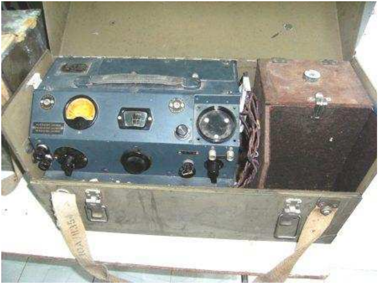
Dan huwa r-riċevitur bejn 1.4 MHz u 4 MHz bi tliet valvi
